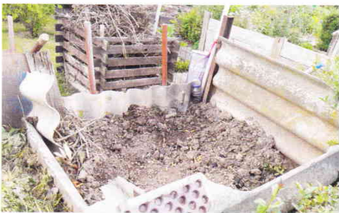
Oft werden in unseren Kleingärten zersägte und beschädigte Wellasbestplatten als Kompostbehälter zweckentfremdet benutzt. Hier müssen die Vereinsvorstände unbedingt eingreifen und die sofortige Beseitigung fordern.
